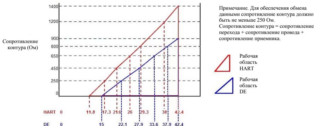
Для DE,  $R_{L\max} = 35 \times (\text{Напряжение источника питания} - 15)$
